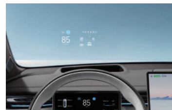
Head-Up Display HD de 27 pulgadas Pantalla de proyección HD de 27 pulgadas: información de conducción clara y precisa de un solo vistazo.
