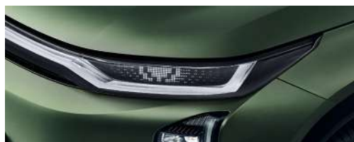
Faros LED de 2,248 píxeles interactivos con IA: Equipados con 8+N modos de iluminación emocional: expresivos y llenos de personalidad.
